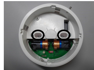
Figura 8 - Posizione dei fori in cui inserire la vite
