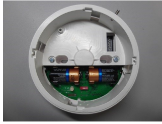
Figura 2 - Vista dall'alto della sirena base wireless
