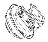
Rimuovere il coperchio del vano batteria dal retro del rilevatore.
