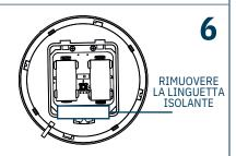
Rimuovere la linguetta isolante delle batterie assicurandosi che le batterie restino correttamente inserite nel loro alloggiamento.
