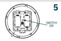
Assicurarsi che lo switch di programmazione nella base del rilevatore sia in posizione ON.
