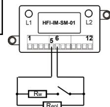
Il mini-modulo di ingresso a singolo canale supervisionato **HFI-IM-SM-01** consente il monitoraggio di dispositivi antincendio e di supervisione a contatto aperto.
