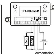
Il mini-modulo **HFI-OM-SM-01** a singolo canale supervisionato di uscita consente il controllo, mediante la chiusura di contatti, di dispositivi ausiliari come, ad esempio, porte tagliafuoco.
