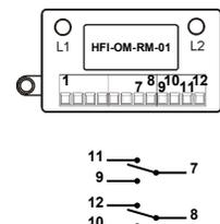
Il mini-modulo di uscita **HFI-OM-RM-01** a singolo canale relè consente la commutazione di contatti per il controllo di dispositivi ausiliari come porte tagliafuoco.
